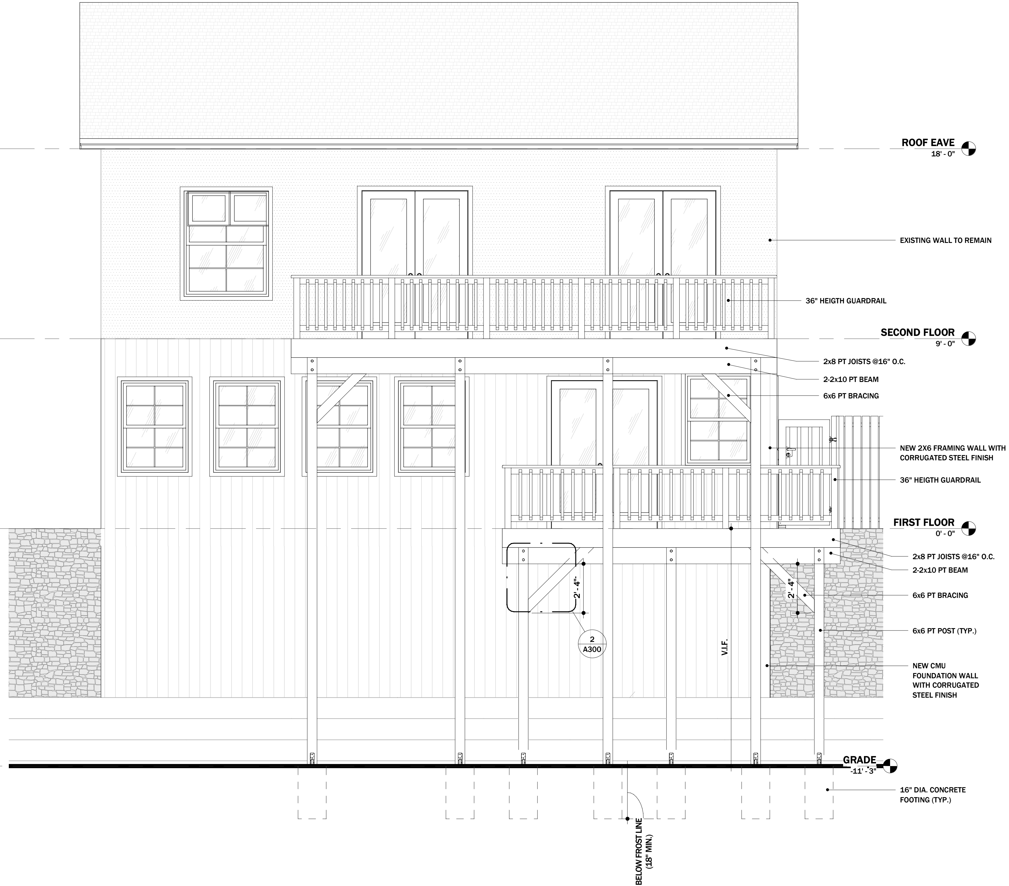
1 REAR ELEVATION SCALE: 3/8" = 1'-0"
